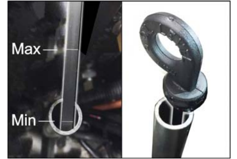
صورة: قياس مستوى الزيت مع محرك البنزين/الغاز (.../125 KM و.../105 KM)
