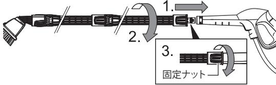
1. お持ちの高圧洗浄機のトリガーガン先端に、組み立てたデッキクリーナーをしっかり押し込みます。
