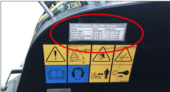
Figure : Autocollant dans la cabine du conducteur avec pressions de gonflage recommandées
