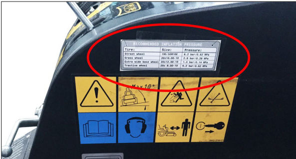
Abbildung: Aufkleber in der Fahrerkabine mit empfohlenen Reifenfülldrücken
