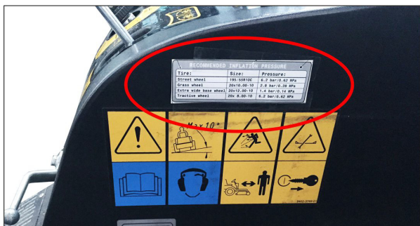
Figura: Adesivo nella cabina conducente con le pressioni dei pneumatici consigliate
